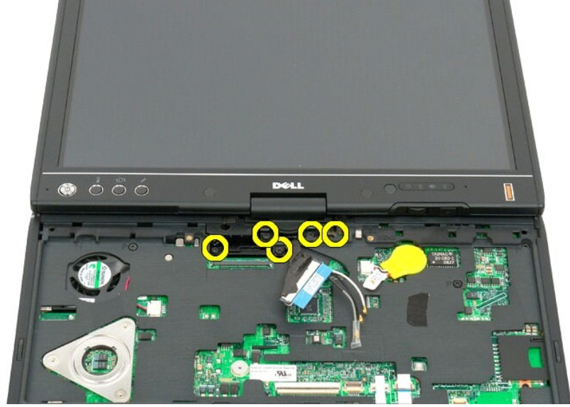
11. ارفع مجموعة الشاشة لأعلى بشكل مستقيم لفصلها عن الكمبيوتر اللوحي.
