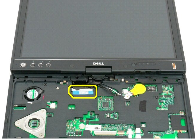
9. تم بسحب كابلات الهوائي من الجزء الداخلي للكمبيوتر اللوحي.
