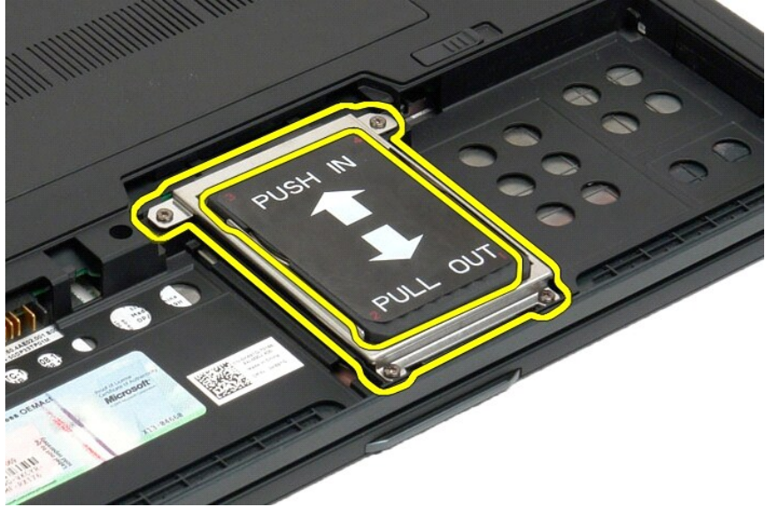
5. ادفع محرك الأقراص الصلبة باتجاه حافة الكمبيوتر اللوحي لفصله عن لوحة النظام.
