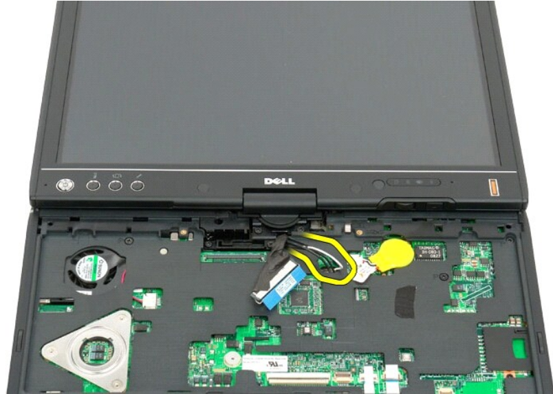
01. ازرع المسامير الاربعة الخمسة التي تثبت مجموعة الشاشة بالكمبيوتر اللوحي.
