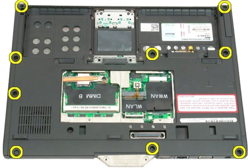
8. اقلب الكمبيوتر اللوحي وانزع المسامير الثلاثة التي تثبت مسند راحة اليد بالجزء العلوي للكمبيوتر اللوحي.
