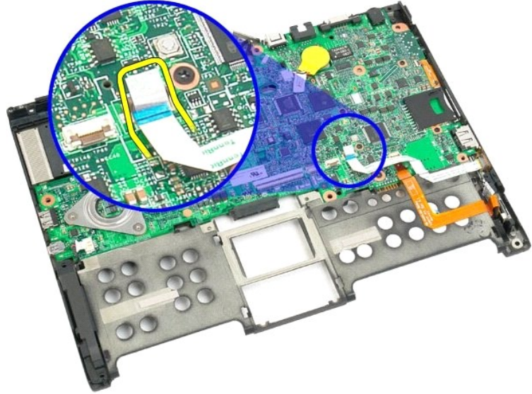
71. قم برفع مشبك التثبيت الموجود على موصل الكابل اللاسلكي.
