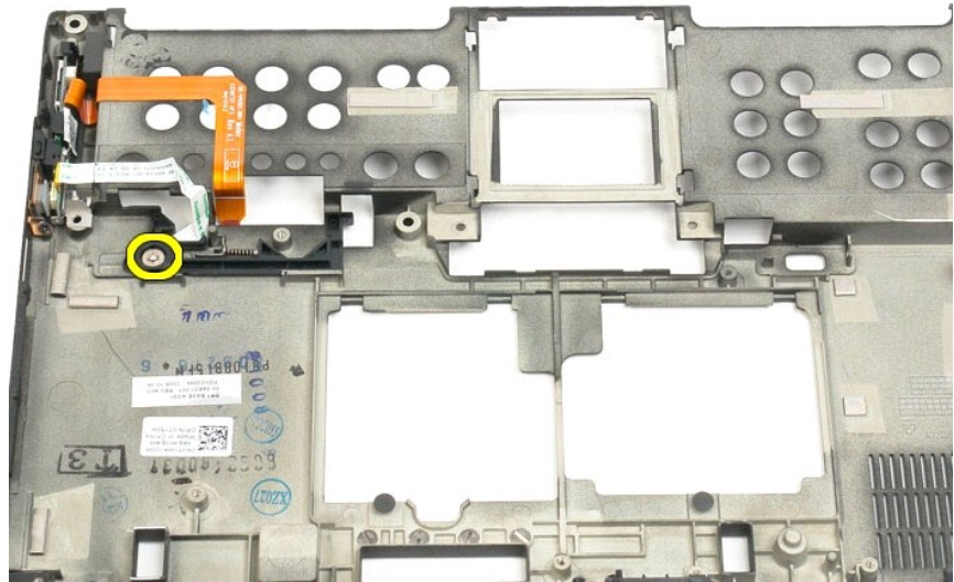
91. ادفع مجموعة المزلاج الداخلية جهة اليمين ثم ارفعها خارج المادة البلاستيكية بالجزء السفلي.
